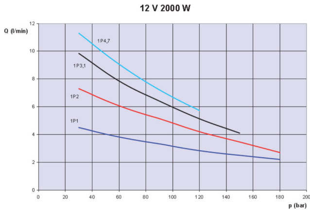
Kurve for leveringsmengde liter/min i forhold til trykk bar
